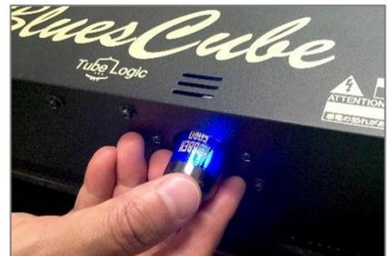
アンプ背面のスロットに「トーンカプセル」を装着
